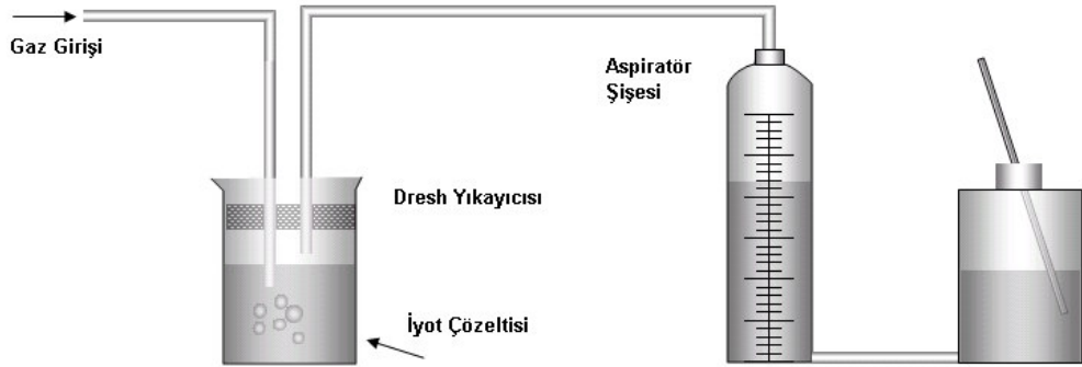
Reich Yöntemi İle SO 2 Analizi Deney Düzeni
